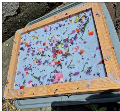
Mit Blüten und Farbpigmenten in der Pulpe erhält man entsprechend strukturiertes Papier.
